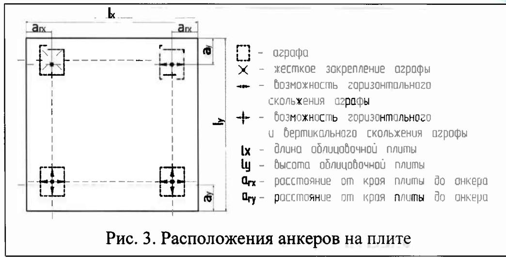
**4.5.2.** Обработка отверстий с внутренней подрезкой под анкера производится только на специализированном оборудовании с использованием специального инструмента Fischerwerke GmbH&Co, KG в заводских условиях или в специально подготовленных и оборудованных в соответствии с требованиями и инструкциями завода-изготовителя помещениях. Не допускается выполнение операций в необорудованных помещениях, на площадках, лесах, люльках и т.д.
